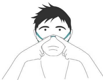
Obrázok E.6 – Stlačenie nosového mostíka
